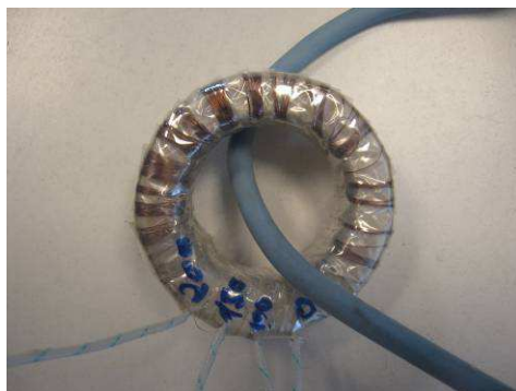
Slika 4 – Izgled gotovog transformatora
